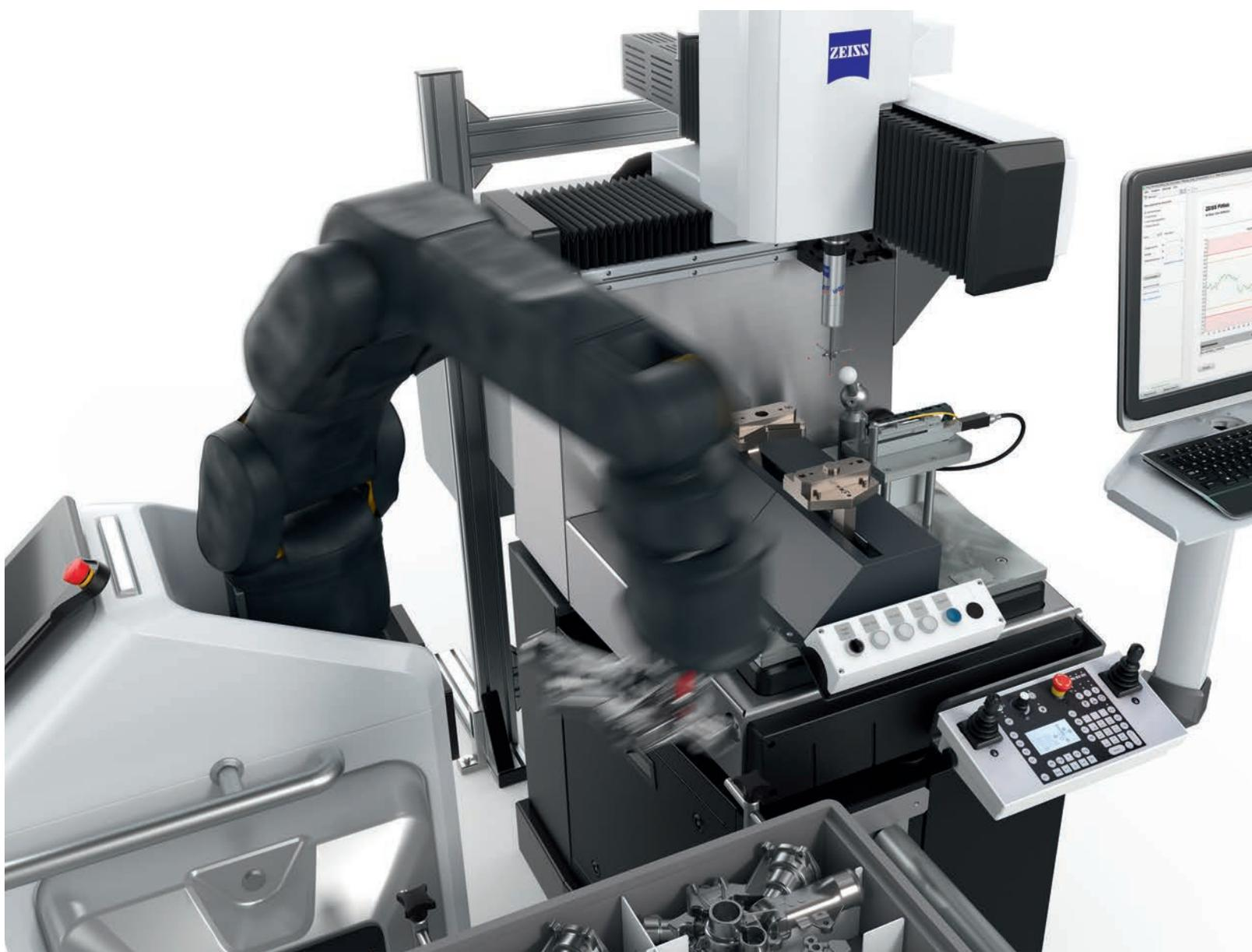
该测量系统灵活性强，由一个协作机器人和一台ZEISS DuraMax HTG组成，大大降低了计量工程师的日常工作量，同时提高了生产率。
