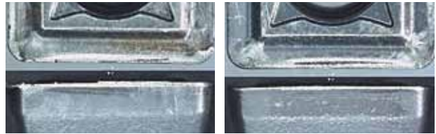
刀片磨损量照片 (加工5孔后) Photo of insert wear width (after 5 holes)
